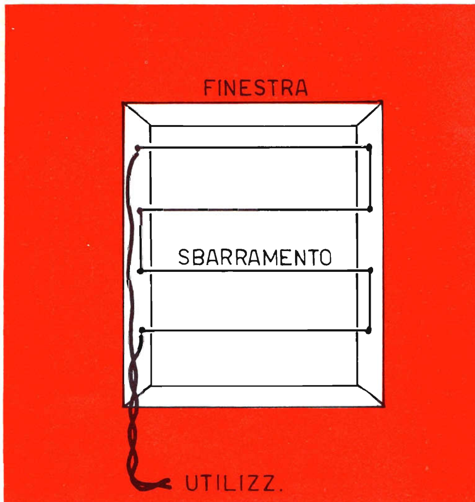
Fig. 6 - Esempio di applicazione dell'antifurto descritto in queste pagine. Sulla finestra si applica un sistema di « conduttori d'allarme », incollandoli direttamente sul vetro. Quando i ladri rompono il vetro, con esso interrompono anche la continuità dei conduttori e il sistema d'allarme entra in funzione.
